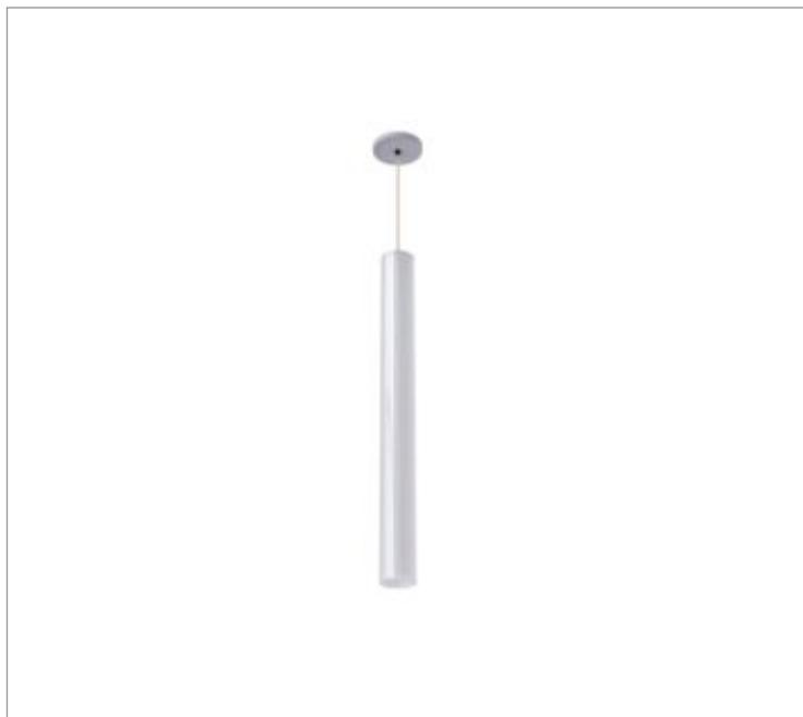
Luminária circular pendente iluminação direta e indireta, 20W 3000K IRC>95. Corpo em acrílico. Acabamento Branca, Preta ou Especial. Controle óptico principal através de difusor extrudado. Luminária grau de proteção IP-20. Driver corrente constante Liga/Desliga, Triac, 1-10V ou Dali (consultar condições). Tensão de trabalho 220V ou Bivolt.
