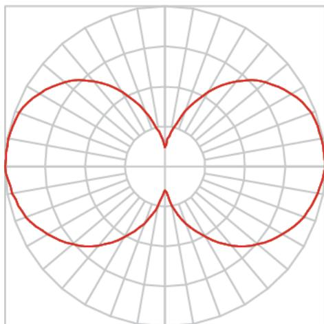
Luminária circular pendente iluminação direta e indireta, 40W 3000K IRC>80. Corpo em acrílico. Acabamento Branca, Preta ou Especial. Controle óptico principal através de difusor extrudado. Luminária grau de proteção IP-20. Driver corrente constante Liga/Desliga, Triac, 1-10V ou Dali (consultar condições). Tensão de trabalho 220V ou Bivolt.
