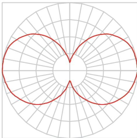
Luminária circular pendente iluminação direta e indireta, 40W 4000K IRC>80. Corpo em acrílico. Acabamento Branca, Preta ou Especial. Controle óptico principal através de difusor extrudado. Luminária grau de proteção IP-20. Driver corrente constante Liga/Desliga, Triac, 1-10V ou Dali (consultar condições). Tensão de trabalho 220V ou Bivolt.
