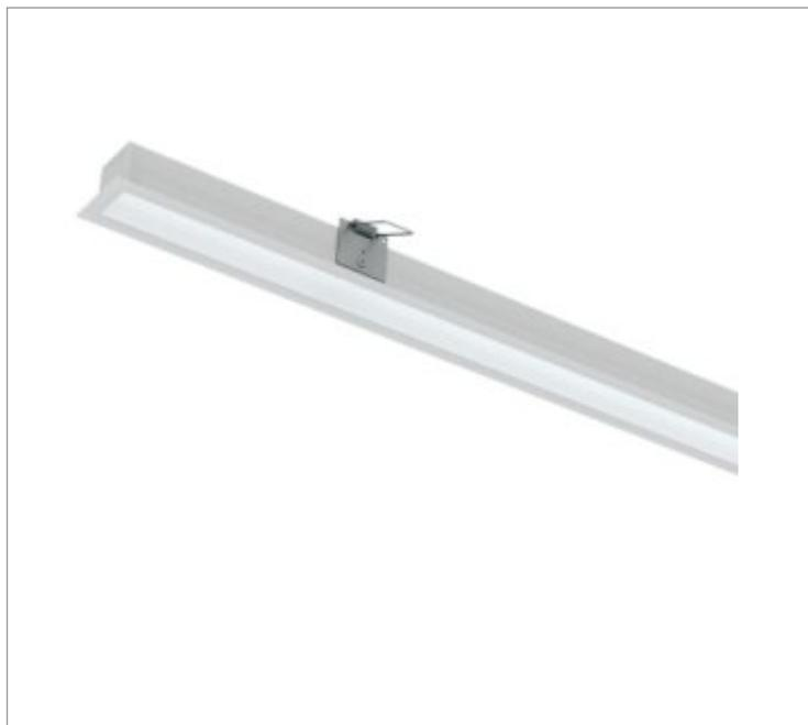
Luminária linear de embutir em forro de gesso, 15Wm 2700K IRC>80. Corpo em alumínio. Acabamento Branca, Preta ou Especial. Controle óptico principal através de difusor extrudado. Luminária grau de proteção IP-20ou65 (consultar condições). Driver corrente constante Liga/Desliga, Triac, 1-10V ou Dali (consultar condições). Tensão de trabalho 220V ou Bivolt.
