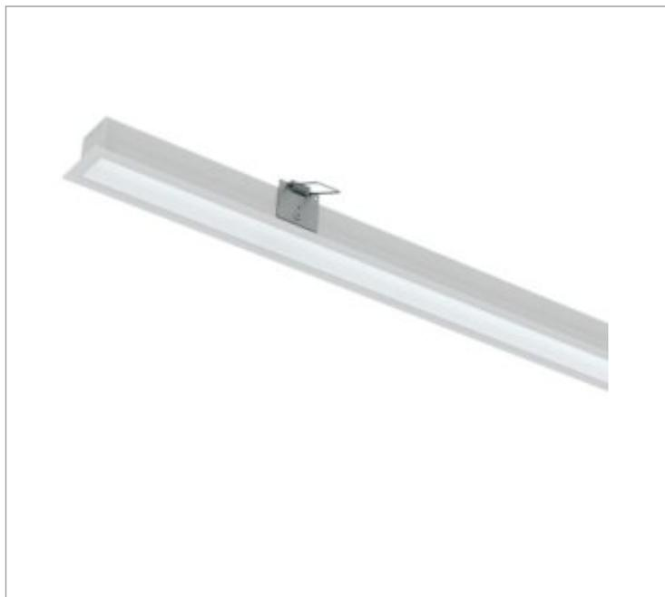
Luminária linear de embutir em forro de gesso, 25Wm 5000K IRC>95. Corpo em alumínio. Acabamento Branca, Preta ou Especial. Controle óptico principal através de difusor extrudado. Luminária grau de proteção IP-20ou65 (consultar condições). Driver corrente constante Liga/Desliga, Triac, 1-10V ou Dali (consultar condições). Tensão de trabalho 220V ou Bivolt.
