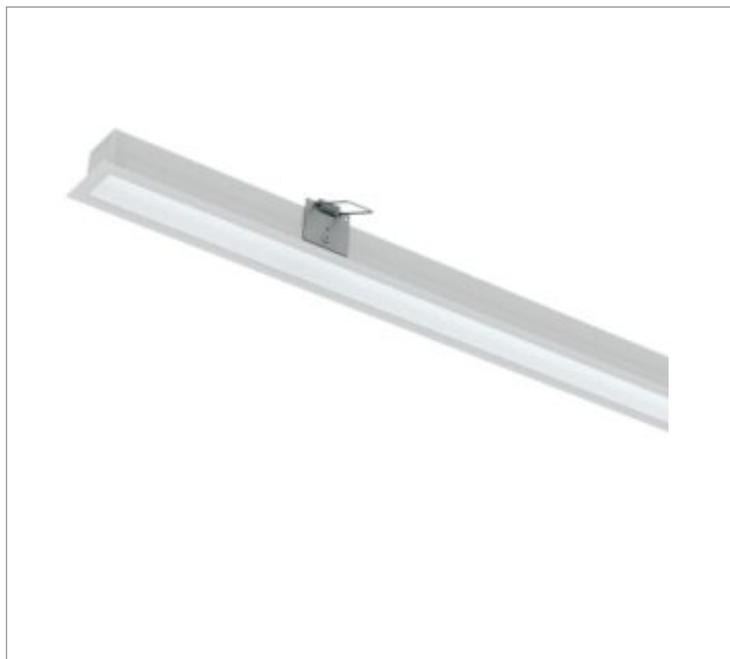
Luminária linear de embutir em forro de gesso, 25Wm 3000K IRC>95. Corpo em alumínio. Acabamento Branca, Preta ou Especial. Controle óptico principal através de difusor em poliestireno translúcido. Luminária grau de proteção IP-20ou65 (consultar condições). Driver corrente constante Liga/Desliga, Triac, 1-10V ou Dali (consultar condições). Tensão de trabalho 220V ou Bivolt.
