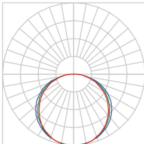
Luminária linear pendente iluminação direta, 15Wm 3000K IRC>80. Corpo em alumínio. Acabamento Branca, Preta ou Especial. Controle óptico principal através de difusor extrudado. Luminária grau de proteção IP-20. Driver corrente constante Liga/Desliga, Triac, 1-10V ou Dali (consultar condições). Tensão de trabalho 220V ou Bivolt.
