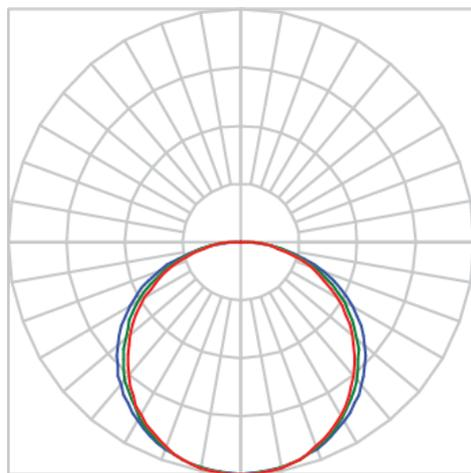
Luminária linear pendente iluminação direta, 25Wm 5000K IRC>80. Corpo em alumínio. Acabamento Branca, Preta ou Especial. Controle óptico principal através de difusor extrudado. Luminária grau de proteção IP-20. Driver corrente constante Liga/Desliga, Triac, 1-10V ou Dali (consultar condições). Tensão de trabalho 220V ou Bivolt.
