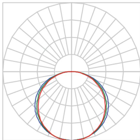
Luminária linear de sobrepor, 15Wm 2700K IRC>80. Corpo em alumínio. Acabamento Branca, Preta ou Especial. Controle óptico principal através de difusor extrudado. Luminária grau de proteção IP-20. Driver corrente constante Liga/Desliga, Triac, 1-10V ou Dali (consultar condições). Tensão de trabalho 220V ou Bivolt.
