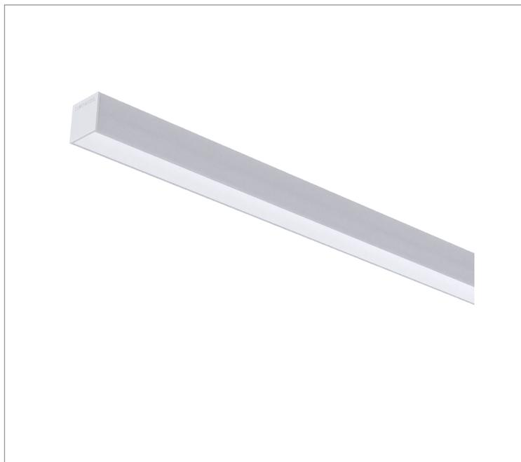
Luminária linear de sobrepor, 25Wm 4000K IRC>80. Corpo em alumínio. Acabamento Branca, Preta ou Especial. Controle óptico principal através de difusor extrudado. Luminária grau de proteção IP-20. Driver corrente constante Liga/Desliga, Triac, 1-10V ou Dali (consultar condições). Tensão de trabalho 220V ou Bivolt.
