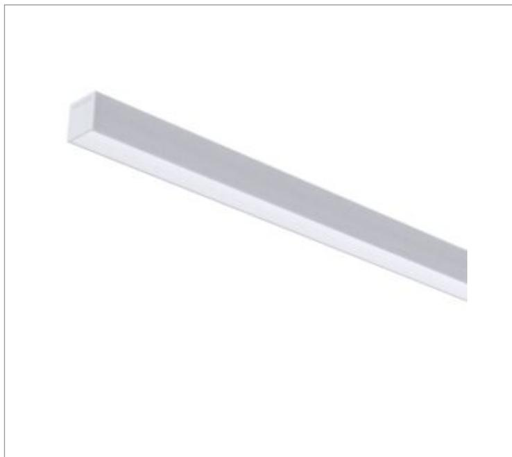
Luminária linear de sobrepor, 25Wm 5000K IRC>80. Corpo em alumínio. Acabamento Branca, Preta ou Especial. Controle óptico principal através de difusor extrudado. Luminária grau de proteção IP-20ou65 (consultar condições). Driver corrente constante Liga/Desliga, Triac, 1-10V ou Dali (consultar condições). Tensão de trabalho 220V ou Bivolt.
