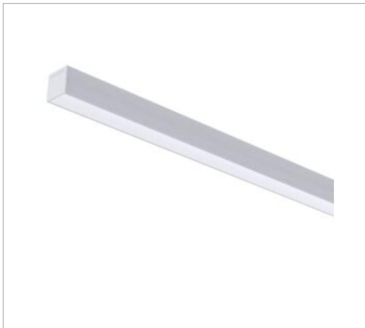
Luminária linear de sobrepor, 15Wm 4000K IRC>95. Corpo em alumínio. Acabamento Branca, Preta ou Especial. Controle óptico principal através de difusor em poliestireno translúcido. Luminária grau de proteção IP-20ou65 (consultar condições). Driver corrente constante Liga/Desliga, Triac, 1-10V ou Dali (consultar condições). Tensão de trabalho 220V ou Bivolt.
