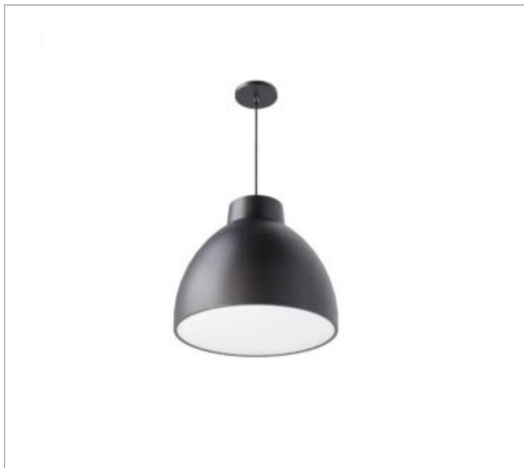
Luminária circular pendente iluminação direta, 20W 2500K IRC>95. Corpo em alumínio. Acabamento Branca, Preta ou Especial. Controle óptico principal através de difusor em acrílico translúcido. Luminária grau de proteção IP-20. Driver corrente constante Liga/Desliga, Triac, 1-10V ou Dali (consultar condições). Tensão de trabalho 220V ou Bivolt.
