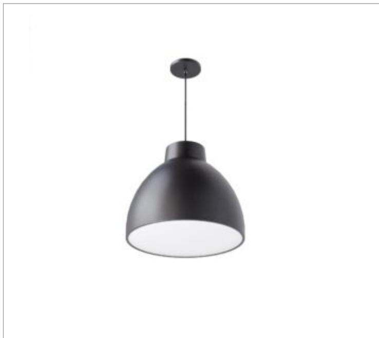
Luminária circular pendente iluminação direta, 28W 3000K IRC>80. Corpo em alumínio. Acabamento Branca, Preta ou Especial. Controle óptico principal através de difusor em acrílico translúcido. Luminária grau de proteção IP-20. Driver corrente constante Liga/Desliga, Triac, 1-10V ou Dali (consultar condições). Tensão de trabalho 220V ou Bivolt.
