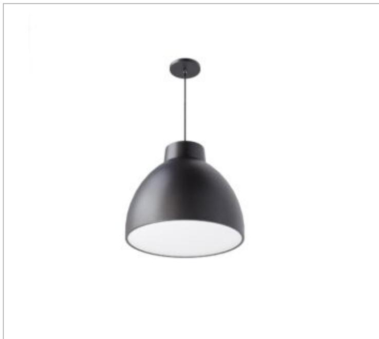
Luminária circular pendente iluminação direta, 20W 2700K IRC>90. Corpo em alumínio. Acabamento Branca, Preta ou Especial. Controle óptico principal através de difusor em poliestireno translúcido. Luminária grau de proteção IP-20. Driver corrente constante Liga/Desliga, Triac, 1-10V ou Dali (consultar condições). Tensão de trabalho 220V ou Bivolt.
