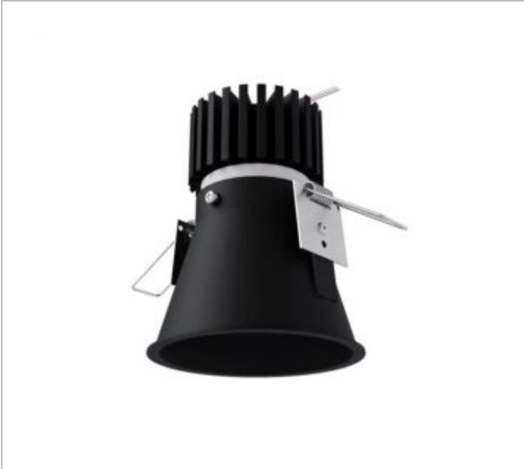
Luminária circular de embutir em forro de gesso, 20W 3000K IRC>80. Corpo em alumínio. Acabamento Preta. Controle óptico principal através de difusor em poliestireno translúcido. Luminária grau de proteção IP-20. Driver corrente constante Liga/Desliga, Triac, 1-10V ou Dali (consultar condições). Tensão de trabalho 220V ou Bivolt.
