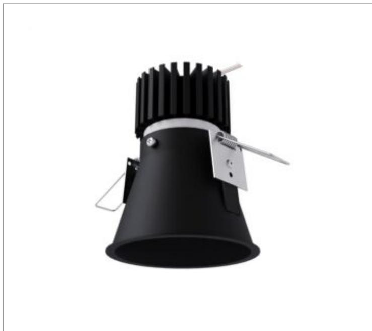
Luminária circular de embutir em forro de gesso, 20W 3000K IRC>95. Corpo em alumínio. Acabamento Preta. Controle óptico principal através de difusor em poliestireno translúcido. Luminária grau de proteção IP-20. Driver corrente constante Liga/Desliga, Triac, 1-10V ou Dali (consultar condições). Tensão de trabalho 220V ou Bivolt.
