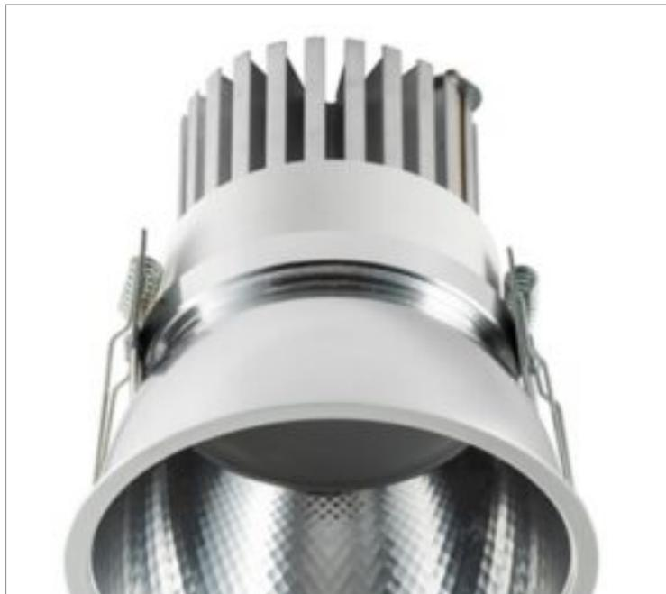
Luminária circular de embutir em forro de gesso, 25W 4000K IRC>90. Corpo em alumínio. Acabamento Branca. Controle óptico principal através de difusor em poliestireno translúcido. Luminária grau de proteção IP-20. Driver corrente constante Liga/Desliga, Triac, 1-10V ou Dali (consultar condições). Tensão de trabalho 220V ou Bivolt.
