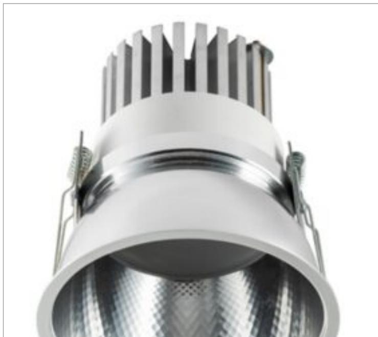
Luminária circular de embutir em forro de gesso, 7W 2500K IRC>95. Corpo em alumínio. Acabamento Branca. Controle óptico principal através de difusor em poliestireno translúcido. Luminária grau de proteção IP-20. Driver corrente constante Liga/Desliga, Triac, 1-10V ou Dali (consultar condições). Tensão de trabalho 220V ou Bivolt.
