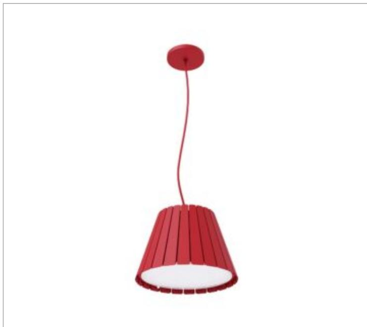
Luminária circular pendente iluminação direta, 14W 4000K IRC>80. Corpo em alumínio. Acabamento Branca. Controle óptico principal através de difusor em poliestireno translúcido. Luminária grau de proteção IP-20. Driver corrente constante Liga/Desliga, Triac, 1-10V ou Dali (consultar condições). Tensão de trabalho 220V ou Bivolt.
