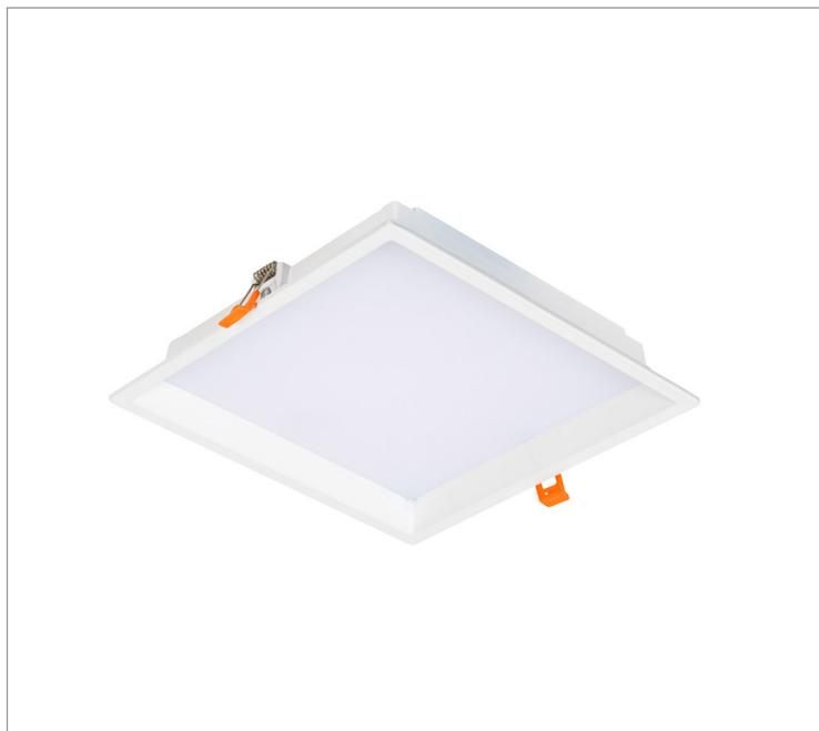
Luminária quadrada de embutir em forro de gesso, 14W 4000K IRC90. Corpo em alumínio injetado. Acabamento branco. Controle óptico principal através de difusor em poliestireno translúcido. Luminária grau de proteção IP-30. Driver corrente constante Liga/Desliga, Triac, 1-10V ou Dali (consultar condições). Tensão de trabalho 220V ou Bivolt.
