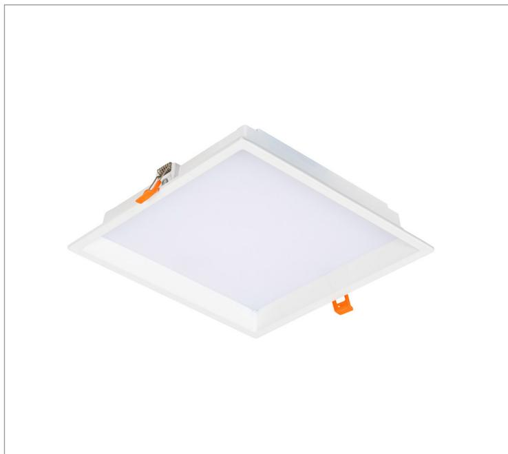
Luminária quadrada de embutir em forro de gesso, 6W 4000K IRC90. Corpo em alumínio injetado. Acabamento branco. Controle óptico principal através de difusor em poliestireno translúcido. Luminária grau de proteção IP-30. Driver corrente constante Liga/Desliga, Triac, 1-10V ou Dali (consultar condições). Tensão de trabalho 220V ou Bivolt.
