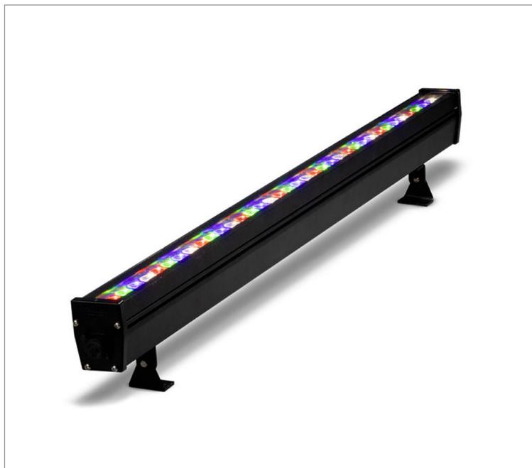
Projeto r linear, 37W 5000K IRC>80. Corpo em alumínio. Acabamento Branca, Preta ou Especial. Controle óptico principal através de lente facho 45°. Luminária grau de proteção IP-65. Driver corrente constante Liga/Desliga, Triac, 1-10V ou Dali (consultar condições). Tensão de trabalho 220V ou Bivolt.
