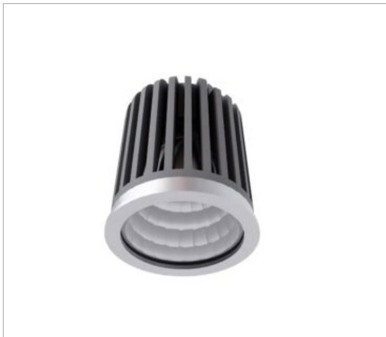
Retrofit circular, 7W 3000K IRC>95. Corpo em alumínio. Acabamento Natural. Controle óptico principal através de refletor facho 60°. Luminária grau de proteção IP-20. Driver corrente constante Liga/Desliga, Triac, 1-10V ou Dali (consultar condições). Tensão de trabalho 220V ou Bivolt.
