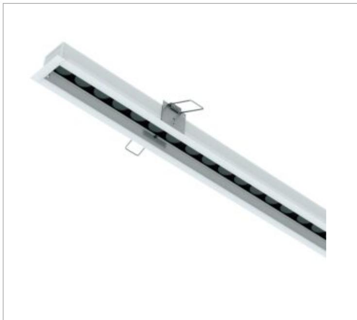
Luminária linear de embutir em forro de gesso, 35Wm 2700K IRC>80. Corpo em alumínio. Acabamento Branca, Preta ou Especial. Controle óptico principal através de lente facho 10-40°. Luminária grau de proteção IP-20ou65 (consultar condições). Driver corrente constante Liga/Desliga, Triac, 1-10V ou Dali (consultar condições). Tensão de trabalho 220V ou Bivolt.
