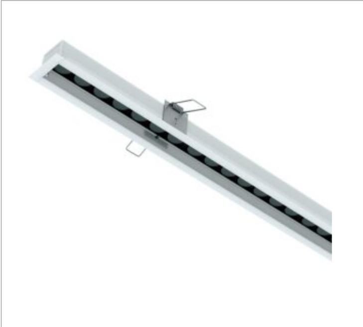
Luminária linear de embutir em forro de gesso, 22Wm 2700K IRC>95. Corpo em alumínio. Acabamento Branca, Preta ou Especial. Controle óptico principal através de lente facho 25°. Luminária grau de proteção IP-20ou65 (consultar condições). Driver corrente constante Liga/Desliga, Triac, 1-10V ou Dali (consultar condições). Tensão de trabalho 220V ou Bivolt.
