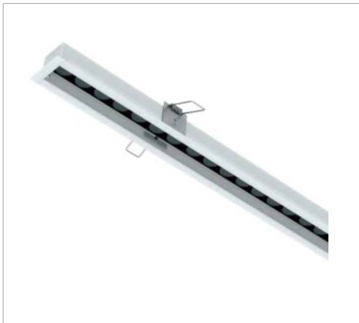
Luminária linear de embutir em forro de gesso, 22Wm 4000K IRC>95. Corpo em alumínio. Acabamento Branca, Preta ou Especial. Controle óptico principal através de lente facho 45°. Luminária grau de proteção IP-20ou65 (consultar condições). Driver corrente constante Liga/Desliga, Triac, 1-10V ou Dali (consultar condições). Tensão de trabalho 220V ou Bivolt.
