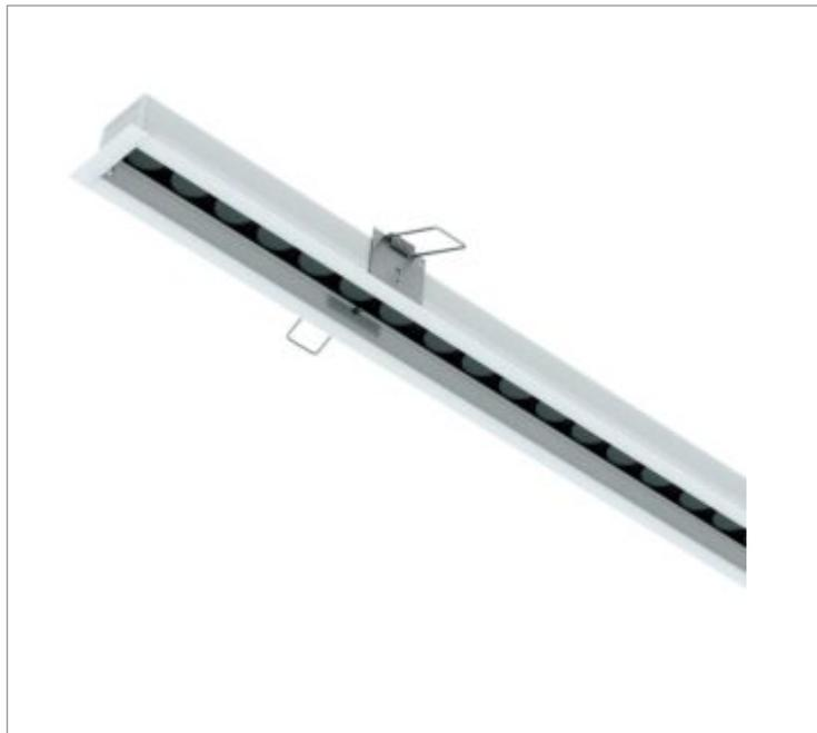
Luminária linear de embutir em forro de gesso, 22Wm 4000K IRC>80. Corpo em alumínio. Acabamento Branca, Preta ou Especial. Controle óptico principal através de lente facho 8°. Luminária grau de proteção IP-20 ou 65 (consultar condições). Driver corrente constante Liga/Desliga, Triac, 1-10V ou Dali (consultar condições). Tensão de trabalho 220V ou Bivolt.
