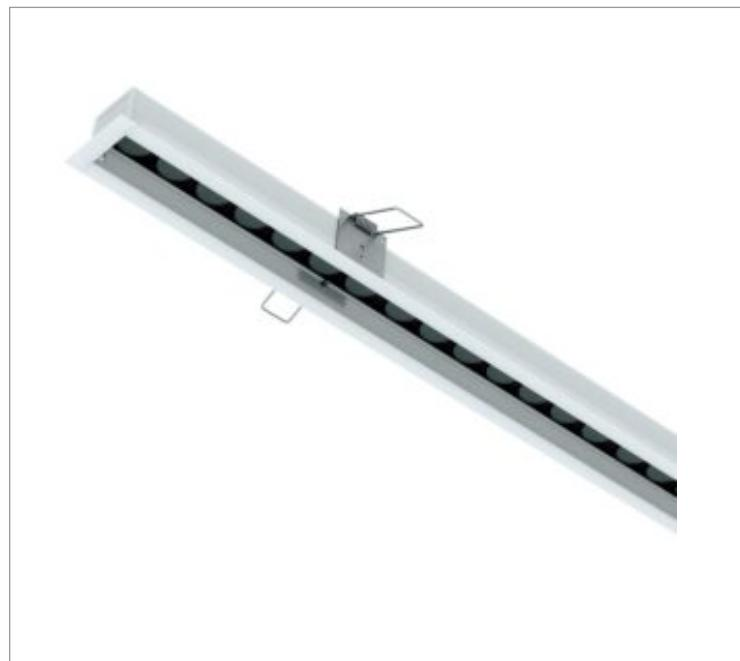
Luminária linear de embutir em forro de gesso, 35Wm 3000K IRC>95. Corpo em alumínio. Acabamento Branca, Preta ou Especial. Controle óptico principal através de lente facho 8°. Luminária grau de proteção IP-20ou65 (consultar condições). Driver corrente constante Liga/Desliga, Triac, 1-10V ou Dali (consultar condições). Tensão de trabalho 220V ou Bivolt.
