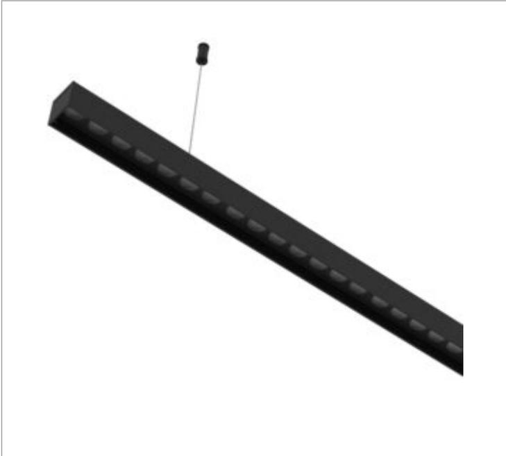
Luminária linear pendente iluminação direta, 22Wm 4000K IRC>80. Corpo em alumínio. Acabamento Branca, Preta ou Especial. Controle óptico principal através de lente facho 8°. Luminária grau de proteção IP-20ou65 (consultar condições). Driver corrente constante Liga/Desliga, Triac, 1-10V ou Dali (consultar condições). Tensão de trabalho 220V ou Bivolt.
