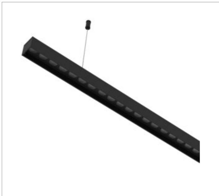
Luminária linear pendente iluminação direta, 35Wm 4000K IRC>80. Corpo em alumínio. Acabamento Branca, Preta ou Especial. Controle óptico principal através de lente facho 8°. Luminária grau de proteção IP-20ou65 (consultar condições). Driver corrente constante Liga/Desliga, Triac, 1-10V ou Dali (consultar condições). Tensão de trabalho 220V ou Bivolt.
