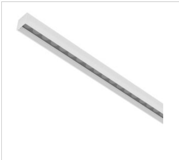
Luminária linear de sobrepor, 35Wm 2700K IRC>80. Corpo em alumínio. Acabamento Branca, Preta ou Especial. Controle óptico principal através de lente facho 8°. Luminária grau de proteção IP-20ou65 (consultar condições). Driver corrente constante Liga/Desliga, Triac, 1-10V ou Dali (consultar condições). Tensão de trabalho 220V ou Bivolt.
