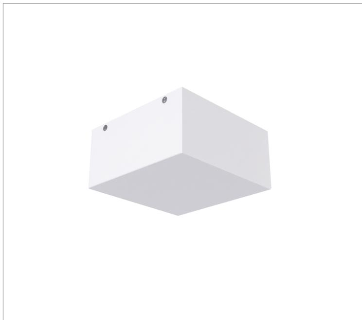
Luminária quadrada de sobrepor, 20W 4000K IRC>80. Corpo em alumínio. Acabamento Branca, Preta ou Especial. Controle óptico principal através de fecho difuso. Luminária grau de proteção IP-20. Driver corrente constante Liga/Desliga, Triac, 1-10V ou Dali (consultar condições). Tensão de trabalho 220V ou Bivolt.
