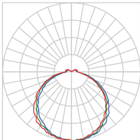
Luminária retangular de sobrepor, 10W 2700K IRC>80. Corpo em alumínio. Acabamento Branca, Preta ou Especial. Controle óptico principal através de fecho difuso. Luminária grau de proteção IP-20. Driver corrente constante Liga/Desliga, Triac, 1-10V ou Dali (consultar condições). Tensão de trabalho 220V ou Bivolt.
