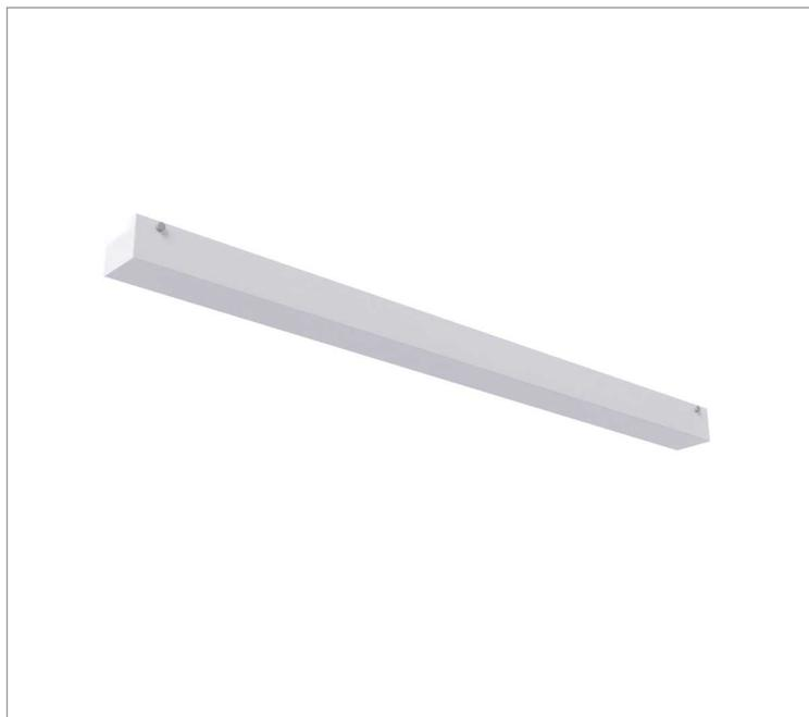
Luminária retangular de sobrepor, 10W 3000K IRC>80. Corpo em alumínio. Acabamento Branca, Preta ou Especial. Controle óptico principal através de fecho difuso. Luminária grau de proteção IP-20. Driver corrente constante Liga/Desliga, Triac, 1-10V ou Dali (consultar condições). Tensão de trabalho 220V ou Bivolt.
