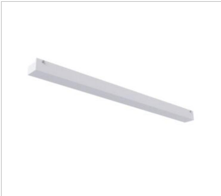
Luminária retangular de sobrepor, 10W 2700K IRC>95. Corpo em alumínio. Acabamento Branca, Preta ou Especial. Controle óptico principal através de fecho difuso. Luminária grau de proteção IP-20. Driver corrente constante Liga/Desliga, Triac, 1-10V ou Dali (consultar condições). Tensão de trabalho 220V ou Bivolt.
