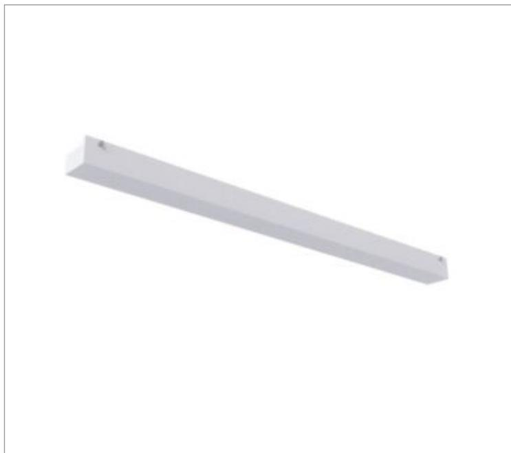
Luminária retangular de sobrepor, 20W 2700K IRC>95. Corpo em alumínio. Acabamento Branca, Preta ou Especial. Controle óptico principal através de fecho difuso. Luminária grau de proteção IP-20. Driver corrente constante Liga/Desliga, Triac, 1-10V ou Dali (consultar condições). Tensão de trabalho 220V ou Bivolt.
