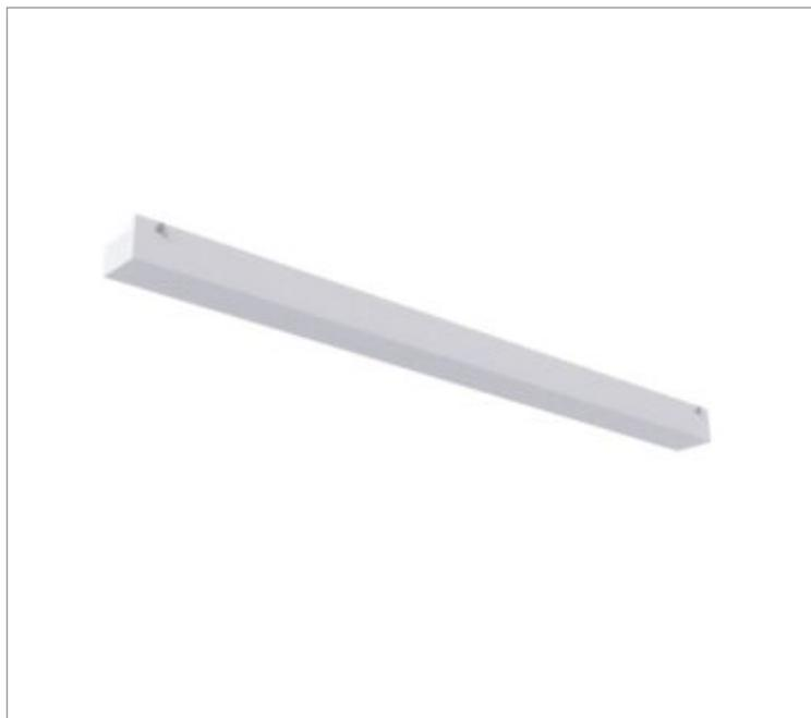
Luminária retangular de sobrepor, 20W 6500K IRC>80. Corpo em alumínio. Acabamento Branca, Preta ou Especial. Controle óptico principal através de fecho difuso. Luminária grau de proteção IP-20. Driver corrente constante Liga/Desliga, Triac, 1-10V ou Dali (consultar condições). Tensão de trabalho 220V ou Bivolt.
