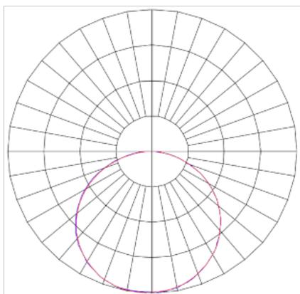
Luminária circular de embutir em forro de gesso, 40W 4000K IRC>80. Corpo em alumínio. Acabamento Branca. Controle óptico principal através de difusor em poliestireno translúcido. Luminária grau de proteção IP-20. Driver corrente constante Liga/Desliga, Triac, 1-10V ou Dali (consultar condições). Tensão de trabalho 220V ou Bivolt.
