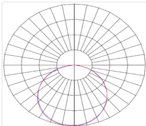
Luminária circular de embutir em forro de gesso, 40W 5000K IRC>80. Corpo em alumínio. Acabamento Preta. Controle óptico principal através de difusor em poliestireno translúcido. Luminária grau de proteção IP-20. Driver corrente constante Liga/Desliga, Triac, 1-10V ou Dali (consultar condições). Tensão de trabalho 220V ou Bivolt.
