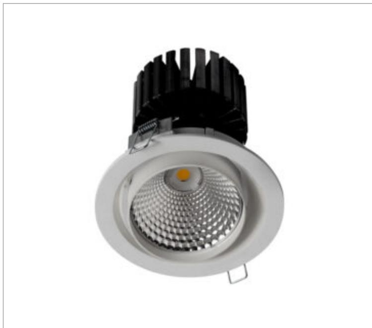
Luminária circular de embutir em forro de gesso, 20W 3000K IRC>95. Corpo em alumínio. Acabamento Branca, Preta ou Especial. Controle óptico principal através de difusor em poliestireno translúcido. Luminária grau de proteção IP-20. Driver corrente constante Liga/Desliga Tensão de trabalho 220V.
