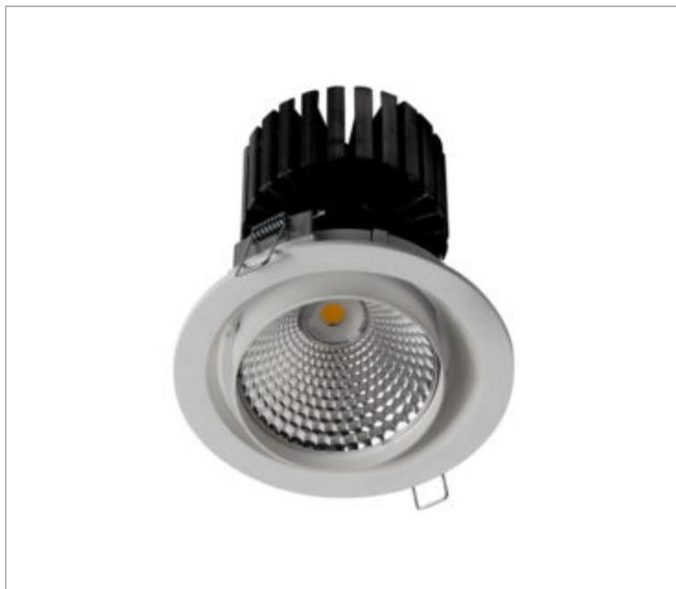
Luminária circular de embutir em forro de gesso, 28W 4000K IRC>90. Corpo em alumínio. Acabamento Branca, Preta ou Especial. Controle óptico principal através de refletor facho 60°. Luminária grau de proteção IP-20. Driver corrente constante Liga/Desliga Tensão de trabalho 220V.
