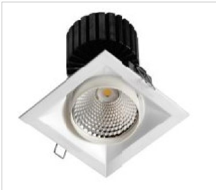
Luminária quadrada de embutir em forro de gesso, 14W 3000K IRC>95. Corpo em alumínio. Acabamento Branca, Preta ou Especial. Controle óptico principal através de difusor em poliestireno translúcido. Luminária grau de proteção IP-20. Driver corrente constante Liga/Desliga Tensão de trabalho 220V.
