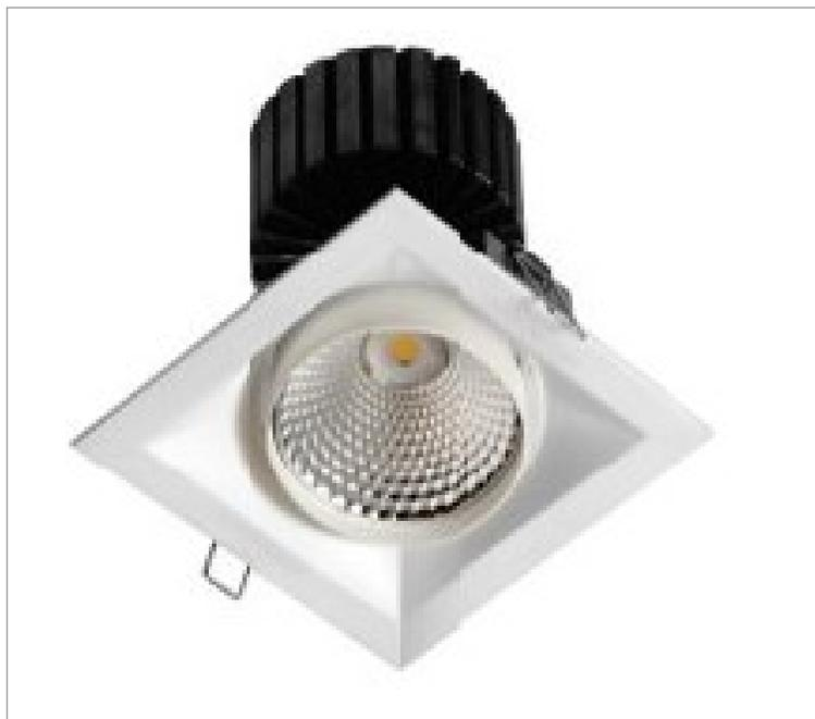
Luminária quadrada de embutir em forro de gesso, 7W 3000K IRC>90. Corpo em alumínio. Acabamento Branca, Preta ou Especial. Controle óptico principal através de difusor em poliestireno translúcido. Luminária grau de proteção IP-20. Driver corrente constante Liga/Desliga Tensão de trabalho 220V.
