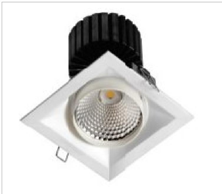
Luminária quadrada de embutir em forro de gesso, 28W 4000K IRC>90. Corpo em alumínio. Acabamento Branca, Preta ou Especial. Controle óptico principal através de refletor facho 24°. Luminária grau de proteção IP-20. Driver corrente constante Liga/Desliga Tensão de trabalho 220V.
