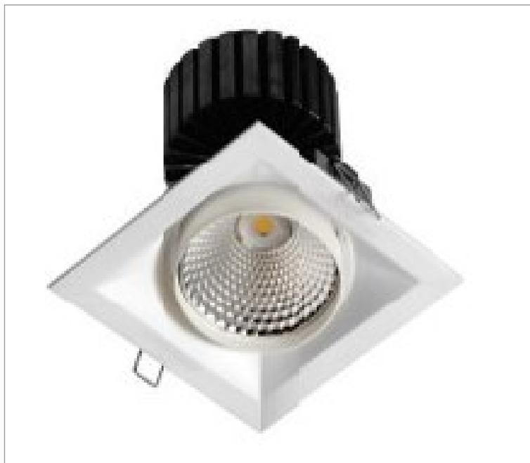
Luminária quadrada de embutir em forro de gesso, 20W 4000K IRC>90. Corpo em alumínio. Acabamento Branca, Preta ou Especial. Controle óptico principal através de refletor facho 60°. Luminária grau de proteção IP-20. Driver corrente constante Liga/Desliga Tensão de trabalho 220V.
