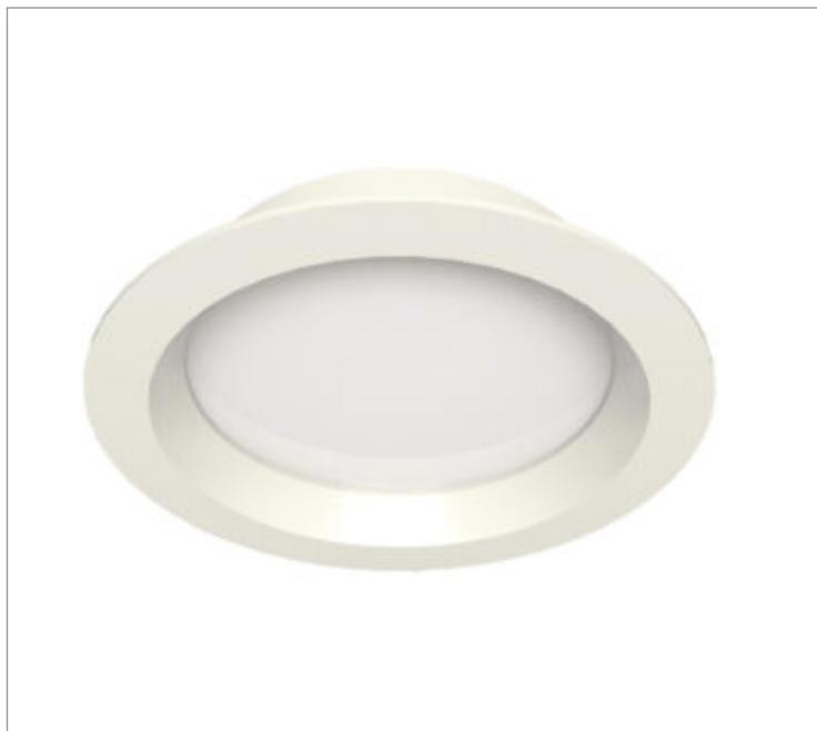
Luminária circular de embutir em forro de gesso, 7W 2700K IRC>95. Corpo em alumínio. Acabamento Branca, Preta ou Especial. Controle óptico principal através de difusor em acrílico translúcido. Luminária grau de proteção IP-20. Driver corrente constante Liga/Desliga, Triac, 1-10V ou Dali (consultar condições). Tensão de trabalho 220V ou Bivolt.
