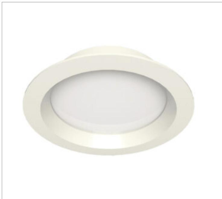
Luminária circular de embutir em forro de gesso, 7W 5000K IRC>95. Corpo em alumínio. Acabamento Branca, Preta ou Especial. Controle óptico principal através de difusor em acrílico translúcido. Luminária grau de proteção IP-20. Driver corrente constante Liga/Desliga, Triac, 1-10V ou Dali (consultar condições). Tensão de trabalho 220V ou Bivolt.
