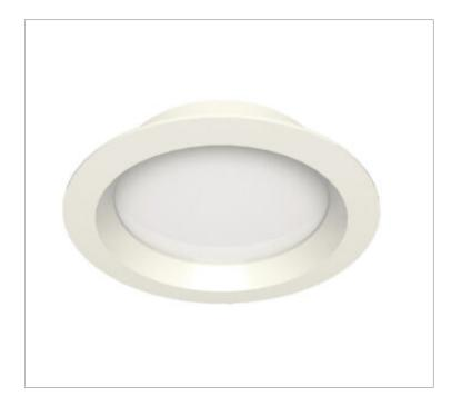
Luminária circular de embutir em forro de gesso, 14W 5000K IRC>95. Corpo em alumínio. Acabamento Branca, Preta ou Especial. Controle óptico principal através de difusor em poliestireno translúcido. Luminária grau de proteção IP-20. Driver corrente constante Liga/Desliga, Triac, 1-10V ou Dali (consultar condições). Tensão de trabalho 220V ou Bivolt.
