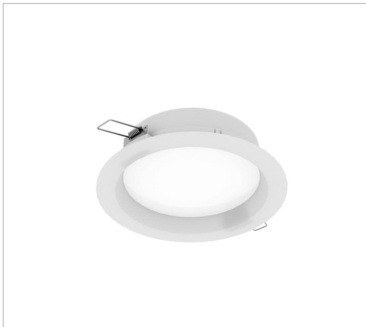
Luminária circular de embutir em forro de gesso, 20W 2700K IRC>80. Corpo em . Acabamento Branca, Preta ou Especial. Controle óptico principal através de difusor em poliestireno translúcido. Luminária grau de proteção IP-20. Driver corrente constante Liga/Desliga, Triac, 1-10V ou Dali (consultar condições). Tensão de trabalho 220V ou Bivolt.
